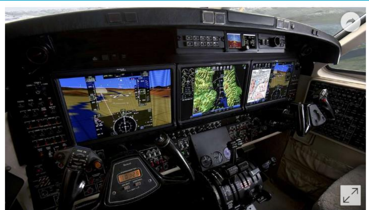
Un tableau de bord de nouvelle génération (baptisé Pro Line Fusion, de Rockwell Collins). On remarque la concentration des informations sur les écrans, la cartographie (à droite) et la superposition de la représentation du paysage (à gauche). L'appareil est un Beechcraft, l'aviation d'affaires intégrant plus rapidement les innovations que les avions de ligne. © Rockwell Collins
